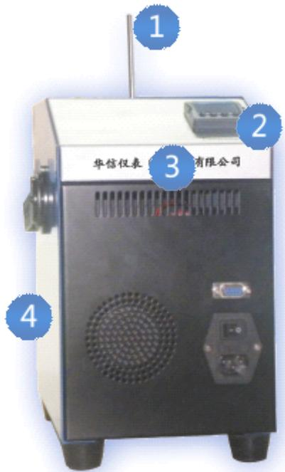
第一步：检查干体校验炉是否有损伤，用提取棒安放好套管（1）。
